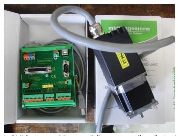
Le DMAC est un module composé d'un moteur et d'une électronique de commande fonctionnant en mode auto-commuté. Ce type de contrôle permet de garantir à tout moment la position du moteur grâce au codeur incrémental intégré. Moteur pas à pas, contrôle de la position, de la vitesse et du couple.
