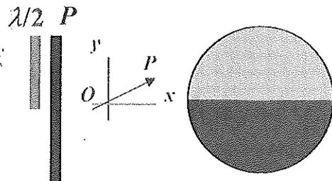
**Mesure :** La mesure de la rotation s'effectue par égalisation des teintes des deux parties. Dans ce cas, la lumière traverse la lame demi-onde suivant un de ses axes principaux, la polarisation qui en est issue est donc inchangée.
