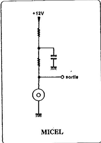
**Attention** à bien respecter le sens des modules repéré par +12V et 0V, risque de détérioration en les branchant à l'envers.
