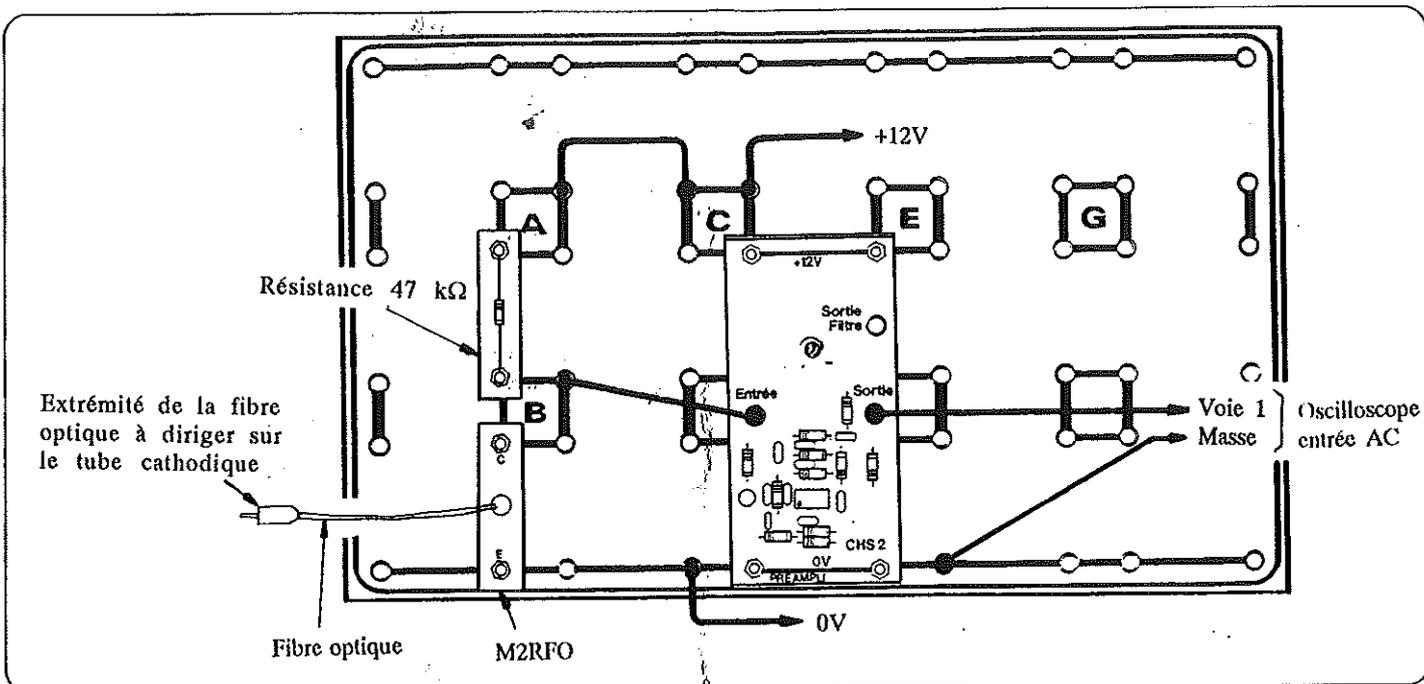
On peut constater une déformation du faisceau lumineux dès que le spot lumineux éclaire l'extrémité de la fibre optique. L'ampli de lumière enregistre une variation de lumière, ce qui a pour effet de créer une impulsion électrique sur la sortie du préamplificateur (CHS2).
