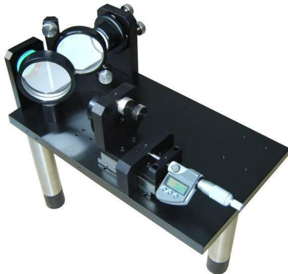
L'interféromètre est un modèle OVIO 202607, il est éclairé par une lanterne 201051 12V-75W. Dans cette expérience, on s'est rapproché du contact optique avec une source mercure 202565. On se propose d'aller vers la teinte plate, directement avec une lampe blanche, en observant les cannelures du spectre en plaçant l'extrémité fibre optique de SpectroVio II dans le champ d'interférences.
