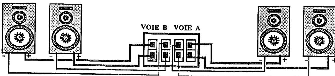
ATTENTION de bien respecter le branchement - et + de l'enceinte A sur la voie A et - et + de l'enceinte B sur la voie B. Un mauvais branchement pourrait entrainer une panne de l'appareil.
