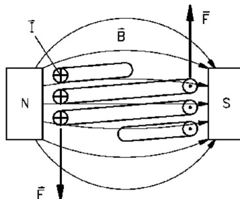
Fig. 2: Principe de fonctionnement du moteur de Lorentz. Les trois grandeurs que sont le courant  $I$ , l'intensité du champ magnétique  $B$  et la force  $F$  sont disposées verticalement les unes par rapport aux autres. Le sens de la force résulte de la règle des trois doigts.
