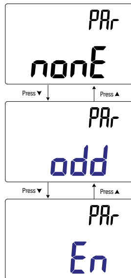
Figure 3-11 Modification du contrôle de parité
