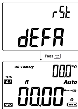
Figure 3-16 Réinitialisation des éléments de configuration
