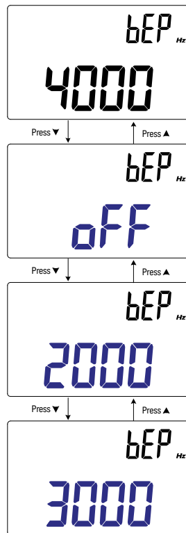
Figure 3-13 Modification de la fréquence du signal sonore
