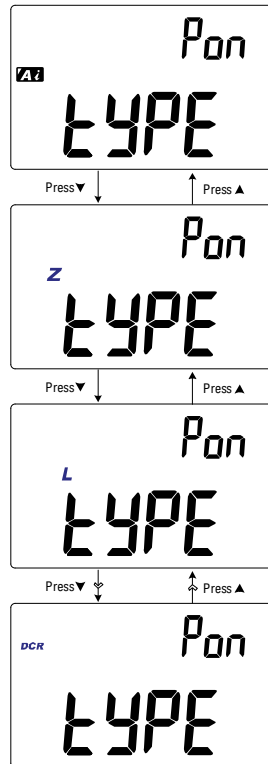
Figure 3-1 Modification du type de mesure au démarrage
