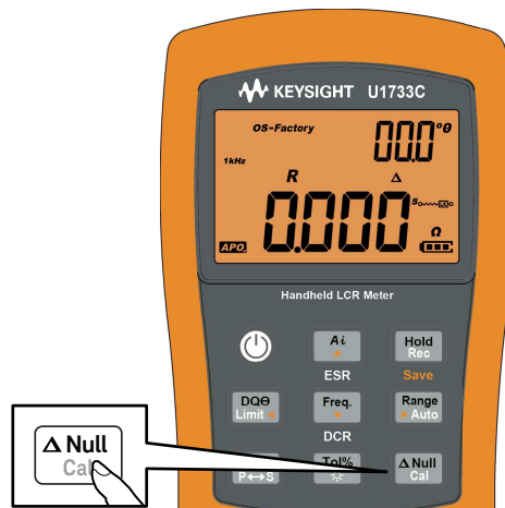
Figure 2-18 Utilisation de la fonction Null
