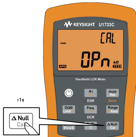
Figure 2-19 Utilisation de la fonction Cal
