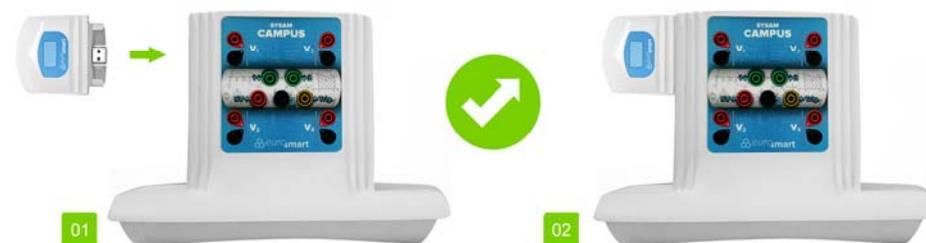
Connecter directement le sonomètre sur un module Bluetooth CAMPUS. Bien veiller à enfoncer le boîtier jusqu'au verrouillage du clip de maintien mécanique. Le module alimente le sonomètre et le reconnaît automatiquement. Le module Bluetooth se connecte ensuite sans fil vers un support informatique disposant d'un récepteur Bluetooth. Celui-ci sera alors reconnu automatiquement par l'application mobile d'Eurosmart.
