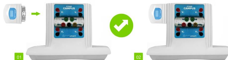
Connecter directement la sonde de température sur un module Bluetooth CAMPUS. Bien veiller à enfoncer le boîtier jusqu'au verrouillage du clip de maintien mécanique. Le module alimente la sonde de température et la reconnaît automatiquement. Le module Bluetooth se connecte ensuite sans fil vers un support informatique disposant d'un récepteur Bluetooth. Celle-ci sera alors reconnue automatiquement par l'application mobile d'Eurosmart.
