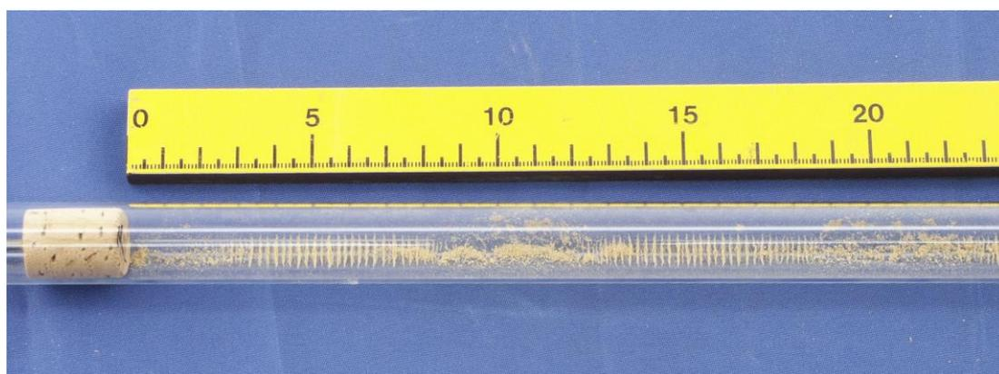
Fig. 1 Détermination de la longueur d'onde
