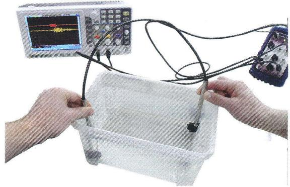
Ces transducteurs sont polyvalents et peuvent être utilisés en émetteur comme en récepteur, ce sont des transducteurs de "contact" qui ne sont pas adaptés pour des transmissions d'ultrasons dans l'air. **Ils doivent être utilisés en immersion dans un milieu liquide, ou en contact avec un milieu solide.**
