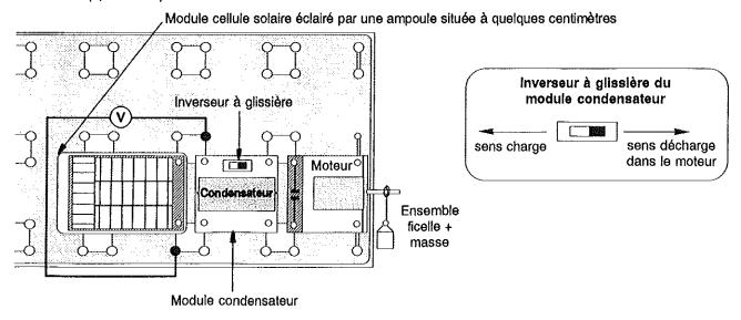
Exemple: pour une tension de charge du condensateur de 4,39 V, l'énergie emmagasinée dans le condensateur est de  $\varepsilon = 1/2$  C . U² = 1/2 . 10 000 .  $10^{-6}$  .  $(4,39)^2 = 96,36$  .  $10^{-3}$  joule.
