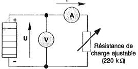
Remarque: sous une lumière constante, relever au préalable le courant maximal que peut foumir la photopile. Pour cela, court-circuiter la résistance de charge. Relever également la tension maximale que peut fournir la photopile, retirer le module résistance de charge de la plaque d'essai P60.
