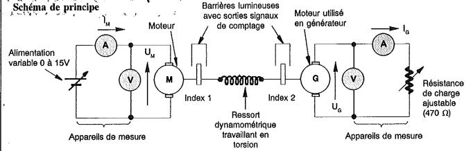
L'utilisation d'un accouplement moteur/génératrice, par un ressort dynamométrique, permet de calculer le moment du couple ( M ), connaissant la constante de torsion (C) du ressort et la puissance mécanique fournie à la génératrice.
