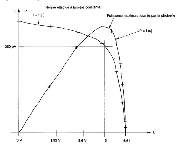
On constate que pour une luminosité constante du module, les cellules photopiles fournissent une puissance maximale pour une tension d'environ 5 V et un courant de 250  $\mu$ A. Cette courbe de puissance en fonction de la tension est importante, pour définir la zone de rendement maximale des cellules photopiles.
