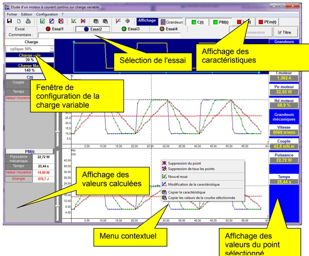
Le logiciel MCC commandera la charge du banc de machine sur une durée totale de 60s selon différents modes de charge.
