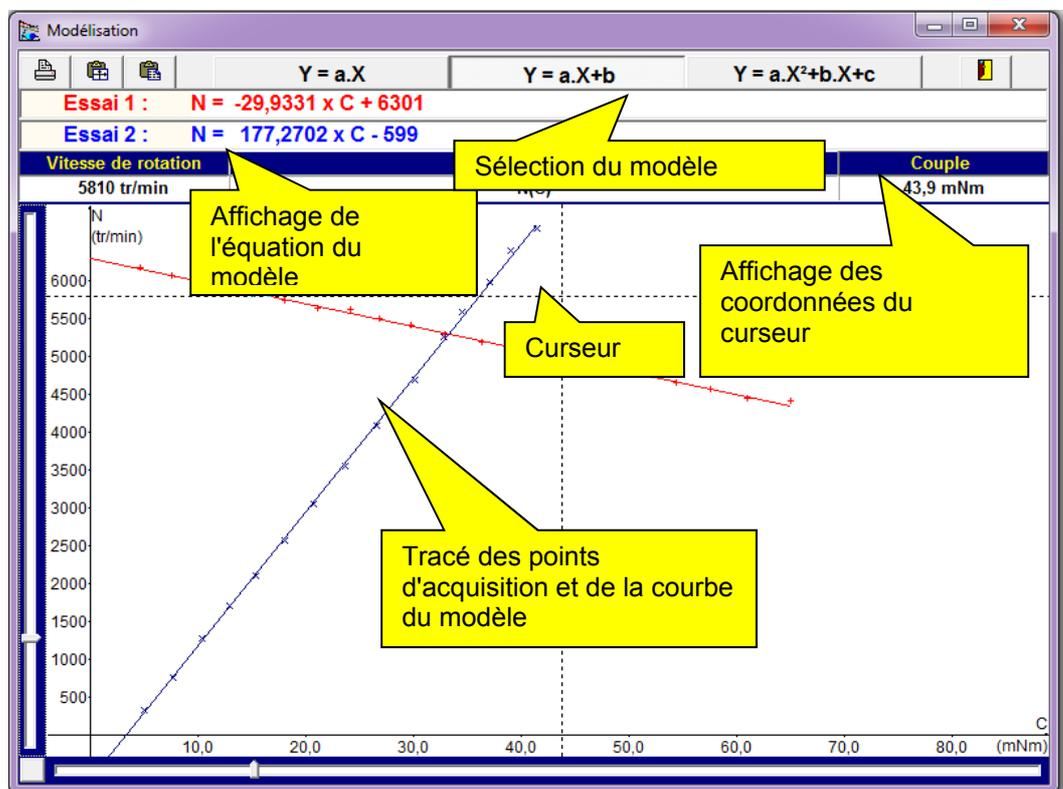
Dans cette fenêtre, il est possible de calculer et d'afficher un modèle linéaire ou parabolique des essais effectués.
