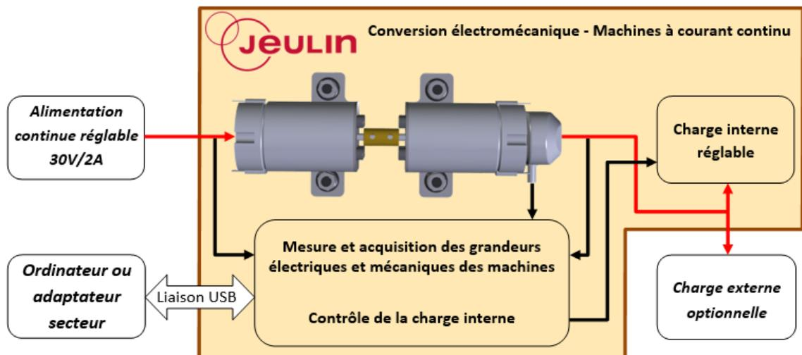
Pour l'étude de la génératrice, le moteur électrique associé joue le rôle d'un générateur mécanique tel que la turbine d'une centrale, une éolienne, un moteur thermique ou la roue entraînant la dynamo d'un vélo ... mais avec une plus grande souplesse d'utilisation.
