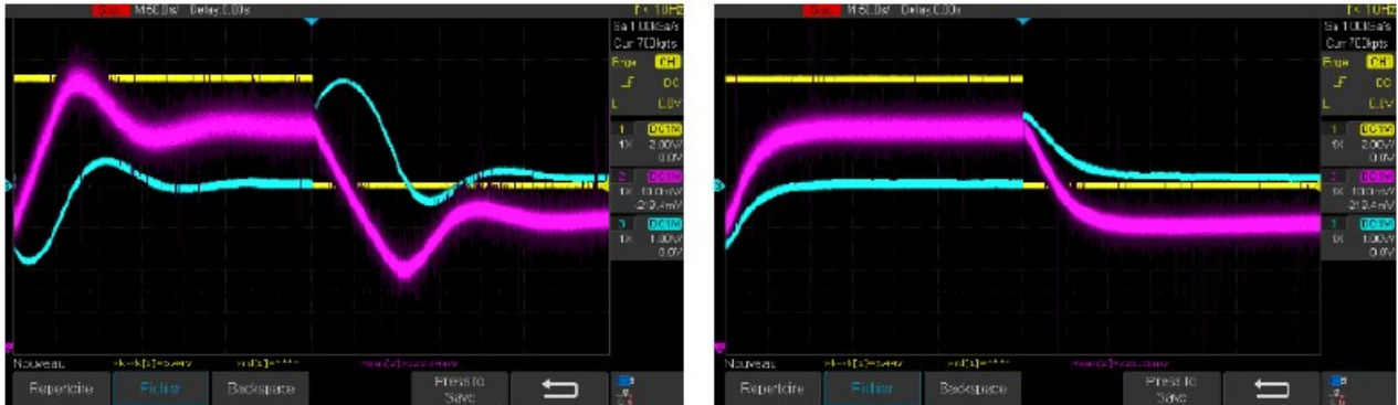
Figure 3 – Deux exemples d'asservissements en mode INTERNE (en jaune : signal de synchronisation (sortie numérique D5), en bleu : courant du module Peltier, en rose : température) : la commande en température est un créneau de 22.0 \pm 1^\circ\text{C} , G_0 = 2 . Figure de droite le temps d'intégration vaut 12 s, de gauche 100 s. La période du signal de commande est de 700 s.
